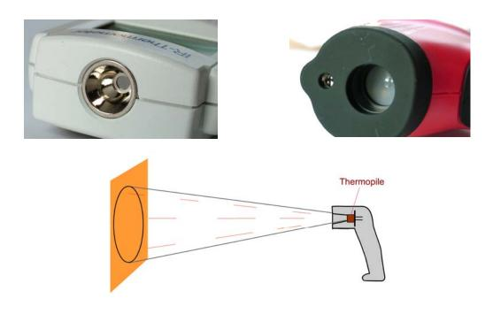
Strahlung trifft auf die schwarze Metallfläche und erwärmt die entsprechenden Kontakte. Die Temperaturdifferenz zwischen dem kalten und heißen Kontakt wird in ein Spannungssignal umgewandelt und als Temperaturwert angezeigt.
